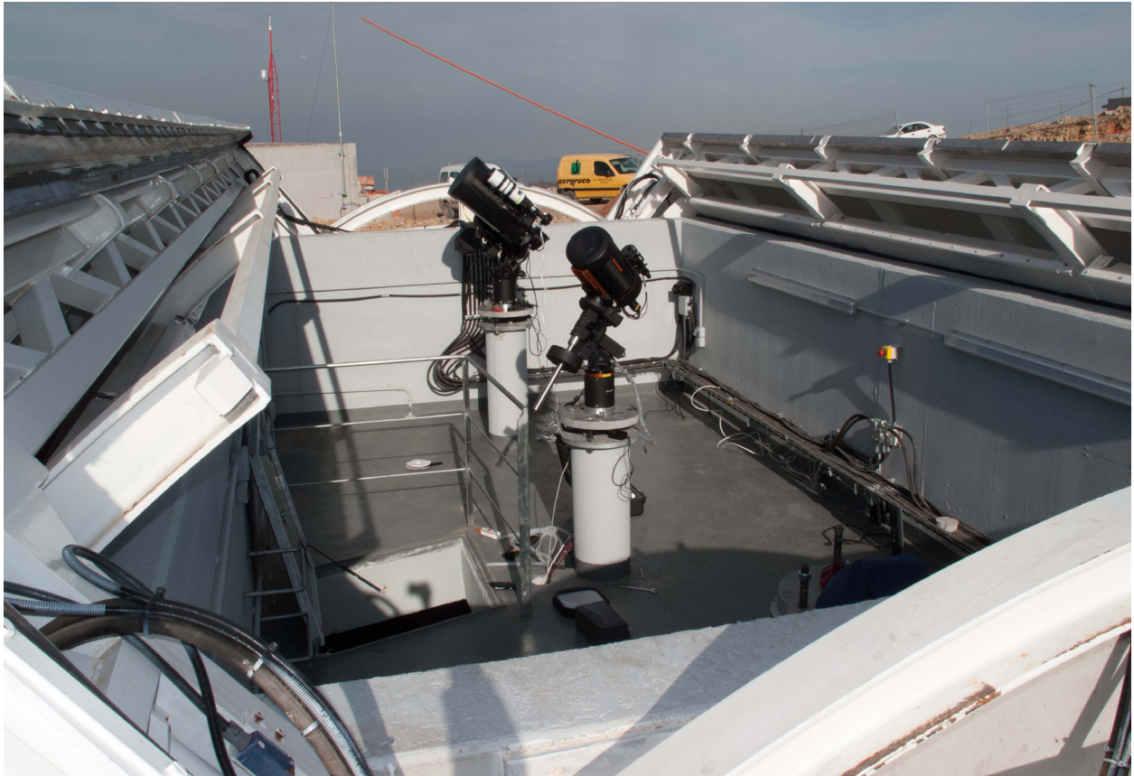
Vista del interior del la Cúpula de Monitores, con los monitores de seeing y extinción.
