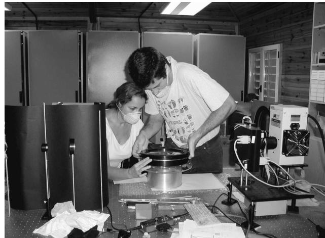
Fig. 9.: Marisa y Ernesto manipulando el colimador durante las pruebas de transmitancia en el laboratorio.
