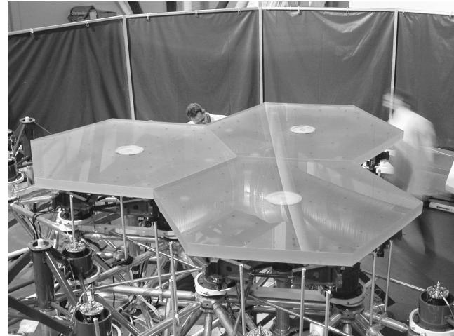
Fig. 4.: Preparación de las pruebas de los segmentos en asociación (Fotografía cortesía de SAGEM/REOSC).
